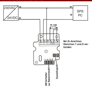
Die Ausgangsspannung ist temperaturlinear. Dabei muss beachtet werden, dass sich der Ausgang nur bis etwa 0,02 V an die untere Versorgungsspannung aussteuern lässt.
