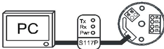
Der Gegenstecker des Messumformers liegt unter einer Plastik-Abdeckkappe verborgen. Sie muss angehoben und entsprechend Bild zur Seite gedreht werden. Die Versorgung des Transmitters erfolgt über das Programmierkabel.
