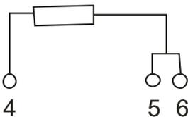
Der Typ 424 kann durch Kurzschluss der Klemmen 5 und 6 auch in **Zweileiterschaltung** betrieben werden. Dabei gehen allerdings die Zuleitungswiderstände mit in das Messergebnis ein. Für geringe Korrekturen kann der Nullpunkt-Regler verstellt werden. Der Spanne-Regler sollte möglichst nicht verstellt werden.
