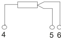
Der Messumformer Typ 424 wird in **Dreileiterschaltung** betrieben, d.h. der Widerstand der Zuleitung geht nicht in das Messergebnis ein, wenn die Leitungen gleich lang sind und aus demselben Leitermaterial bestehen.
