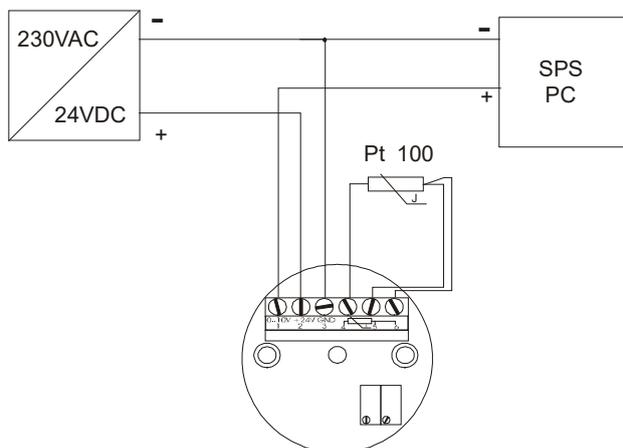
Die Ausgangsspannung folgt linear dem am Eingang anliegendem Temperatursignal. Dabei muss beachtet werden, dass sich der Ausgang nur bis etwa 0,02 V an die untere Versorgungsspannung aussteuern lässt.
